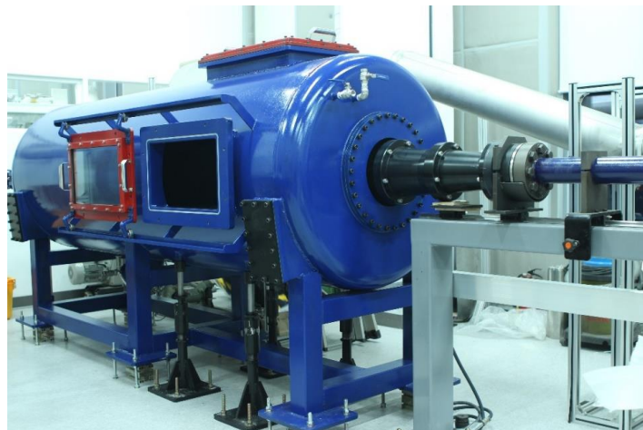
Fig 1. Hypersonic Shock tunnel(IJST2)
